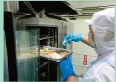
焼きあがった魚は、ひと鉄板につき3か所以上で温度を計測することにより、きちんと火が通っているか確認します。
